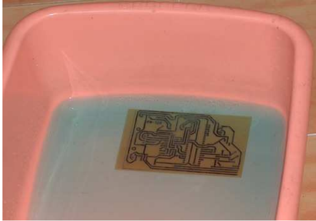
Fotoğraf 9: Açıkta kalan bakır yüzeyin asitte eritilmesi
